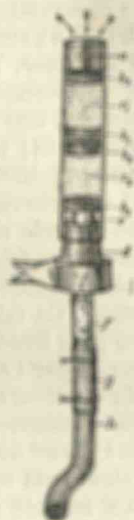
Fig. 30. — Appareil de Pétri pour l'analyse bactériologique de l'air. — L'air pénètre suivant la direction des flèches a; a', a'', sabbote; b; b', b'', b''', disques mulligés de 33 de 30; c, auto; d, tube qui conduit l'air à une pompe.
