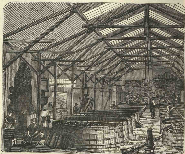
Fig. 264 Atelier pour le cuivrage galvanique des candélabres à gaz.
