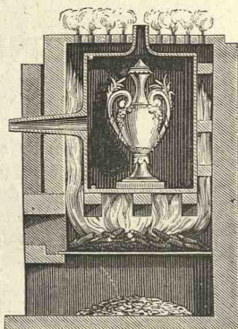
Fig. 85. Mouffle, ou four pour cuire les porcelaines peintes.
