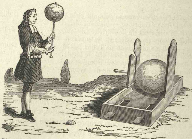
Fig. 197. Première machine électrique (machine d'Otto de Guericke).
