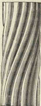
Fig. 248. Câble sous-marin de Douvres à Calais.
