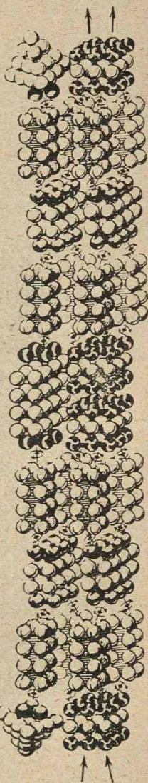
Fig. 380. — Orthosilicate triple d'aluminium, de calcium et de sodium (Type de zéolite, Thomsonite). (\text{SiO}^4)^4\text{Al}^4\text{CaNa}^2 .
